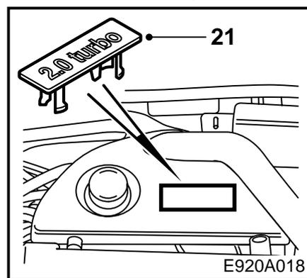
21 Demontera motorns täckåpa, demontera emblemet från täckåpan och montera det nya emblemet. Sätt tillbaka täckåpan.
