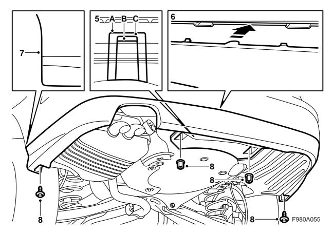
5 **Автомобили с тяговым крюком:** Вырежьте универсальным ножом с крюкообразным лезвием отверстие в бампере для тягового крюка (можно вырезать и прорезной пилой).
