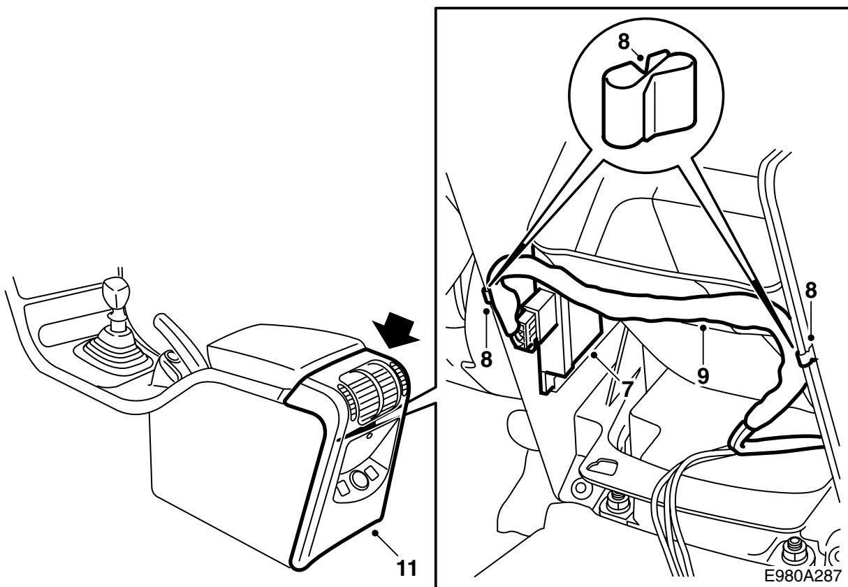
6 レシーバーユニットを回し、コネクターが車両の後方に向くようにする。
