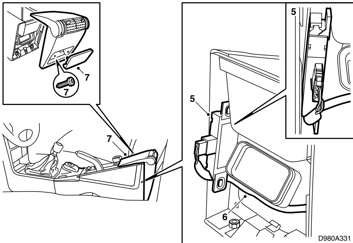
5 レシーバーユニットのワイヤーハーネスをエアダクトの下に引き入れる。レシーバーユニットを半回転し、上の溝に押し戻すが、下の溝の左側にあること。
