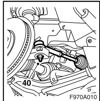
35 サブフレームをボディに向けてリフトアップし、各ボルトを両サイドではめ込む。
