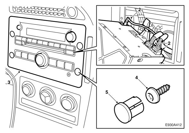
2 ユニットにコネクターとアンテナ接続部を接続する。
