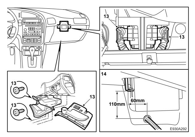
13 Desmontar la guantera y doblar a un lado el borde superior de la alfombrilla. En caso de guantera refrigerada, desmontar la manguera de refrigeración.
