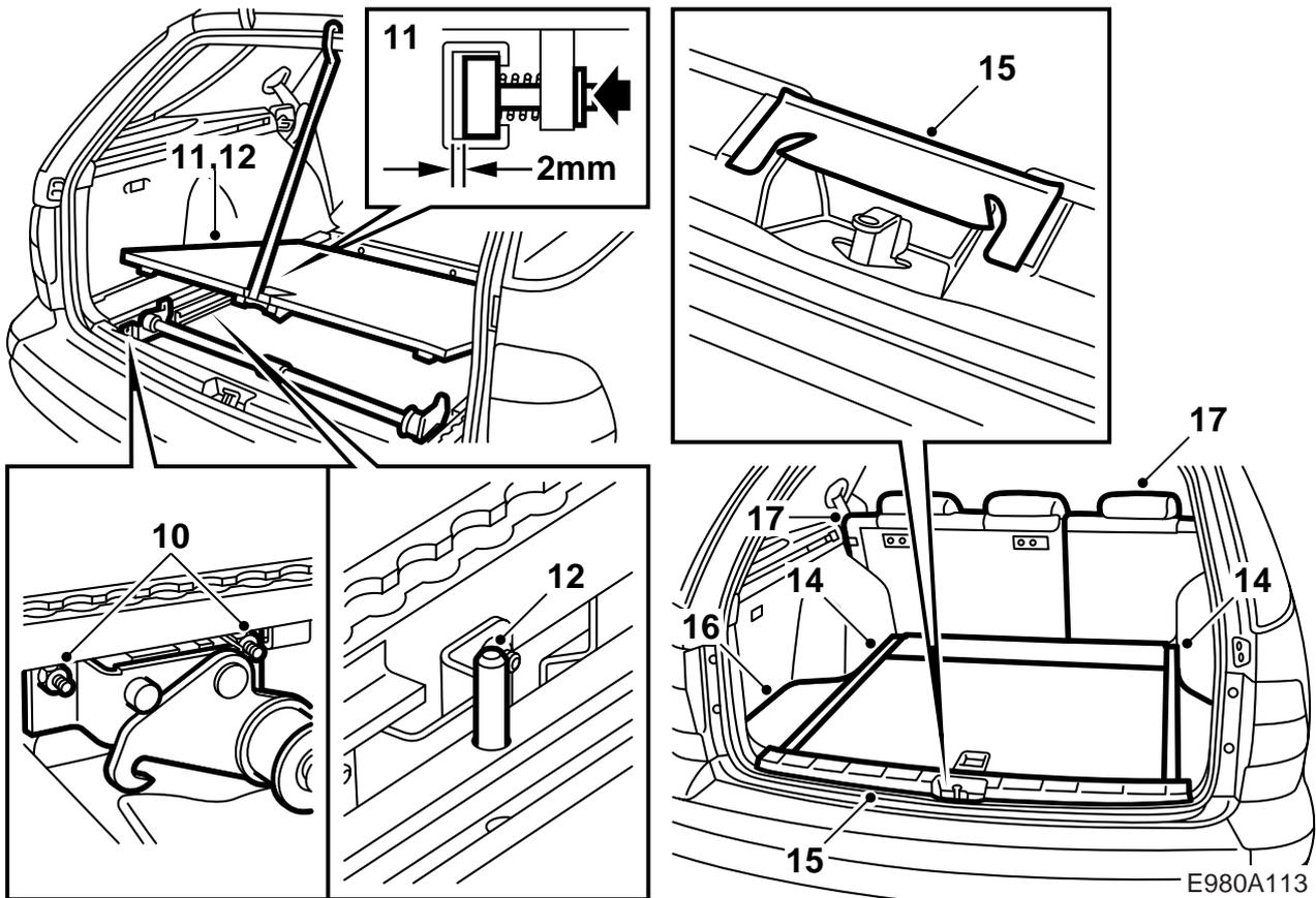
10 Montar los ganchos de bloqueo y los rodillos de deslizamiento en las barras de fijación de carga según la ilustración. Utilizar dos tornillos y contratuercas. Poner algunas gotas de aceite entre los rodillos y los ganchos y secar el posible aceite excesivo.
